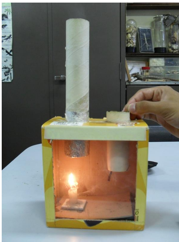
Figura 6. Caixa de vento. A formação de uma corrente de ar a partir da diferença de densidade entre uma massa de ar quente do interior da caixa, que é causado pela vela, a massa de ar frio do incenso.
