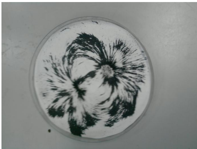
Figura 5. Linhas de força de um ímã. Linhas de força apresentadas a partir de limalhas de ferro em contato com o ímã.
